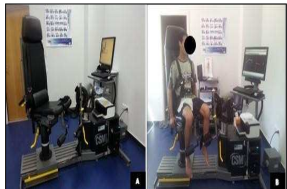
Fig.1: A : Dynamomètre isocinétique de marque Cybex Humac Norm B : Patient installé, effectuant l'évaluation isocinétique du genou gauche
